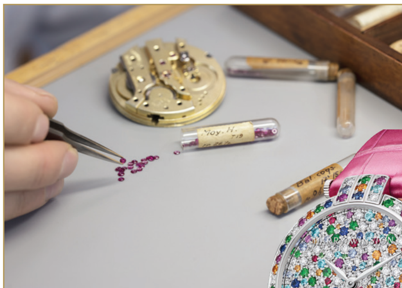
VACHERON CONSTANTIN Colocação de rubis no mecanismo
