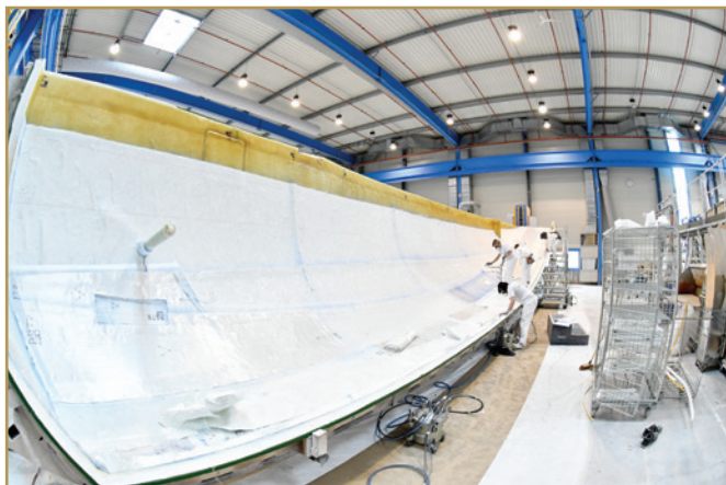
O kit de peças para o casco de um barco inclui cerca de dez materiais
