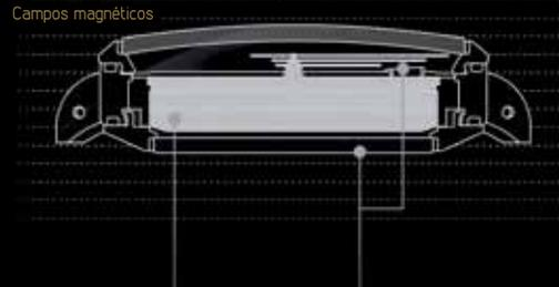
O movimento é antimagnético, não necessitando de uma caixa interior protectora.
